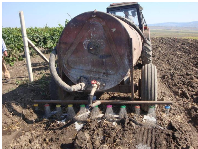
Figura 1: Sus: pomparea urinei depozitate din toaletele școlare în cisterna mobilă. În mijloc: pompa cu vid conectată la țeava de eșapament a tractorului. Jos: utilizarea unui dispozitiv improvizat pentru a distribui urina în câmp înainte de semănatul grâului de toamnă.
